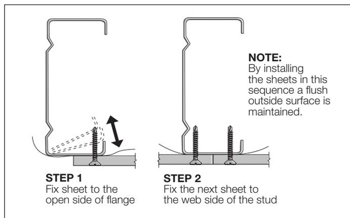
FIGURE 3 SCREW FASTENING
