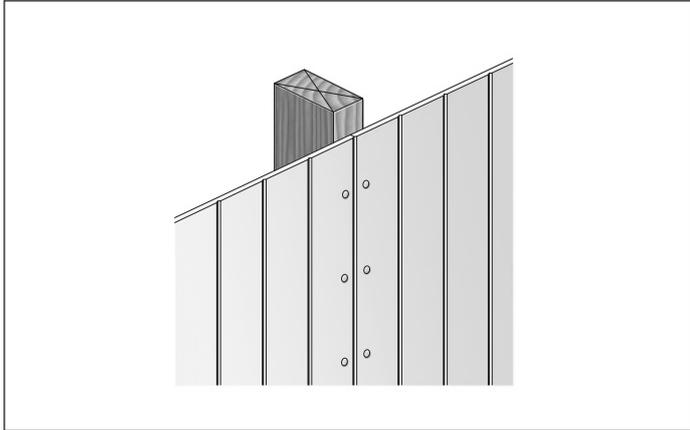
FIGURE 10 BUTT JOINT
