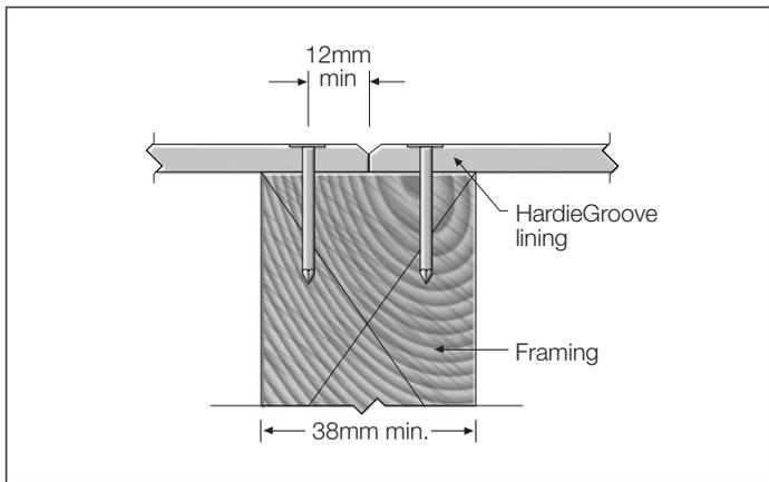
FIGURE 11 BUTT JOINT
