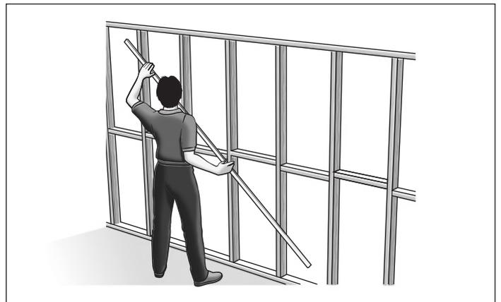
FIGURE 1 FRAME STRAIGHTNESS
